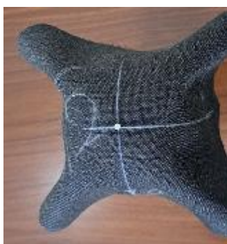
Рис.3. Сравнительная картина складкообразования образца № 2 по основе пропиткой (а) и без пропитки (б) при поведении материала на поверхности шара. Концентрация полимерной композиции - 0,5 г/л.
