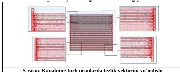
5-rasm. Kanalning turli qismlarda tezlik vektorini yo‘nalishi
