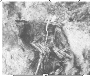
4-mikrofoto (2 nikolda) 5-mikrofoto (1 nikolda) 6-mikrofoto (2 nikolda) 1-6-mikrofotosuratlar. Kuchli karbonatlashgan va nuragan albitlashgan granit-porfirli alevritlarning mikrofotosuratlari.
