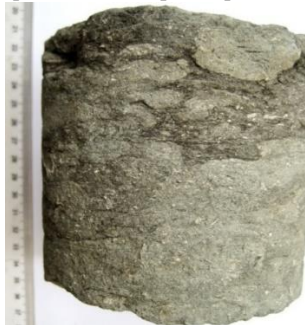
а) разрез оксфордского яруса, инт.1677-1695м. Песчаник среднезернистый, глинистый, известковый, комковатой текстуры
