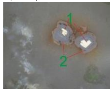
8 - rasm. Briket. 11/18. 1-pirit, 2-temir gidroksidi. Nikon ECLIPSE LV100N POL. 40x. Tosh Jilg'a ma'danli maydon.
