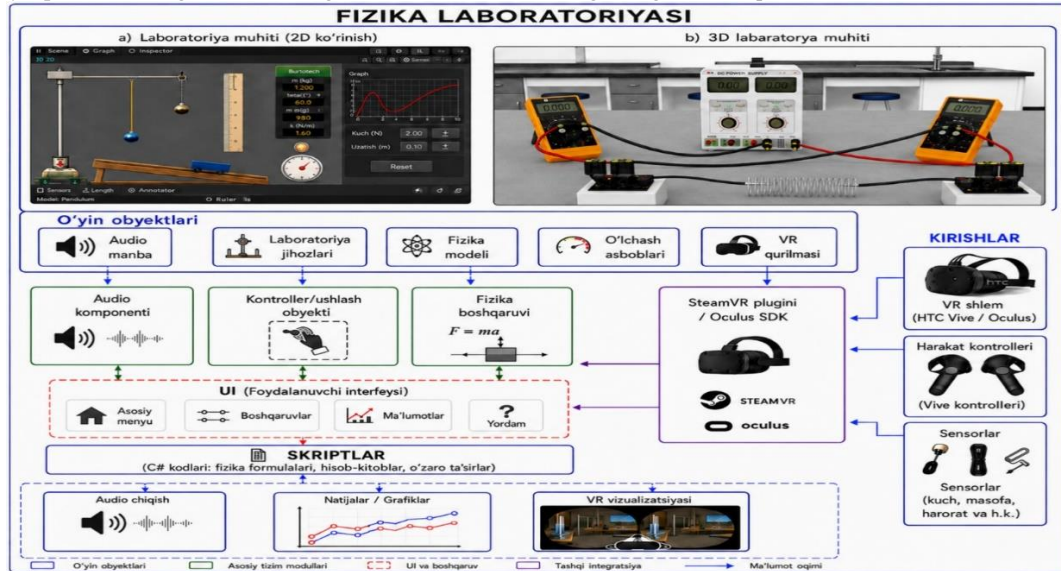
2-rasm: VR texnologiyalari asosida ishlab chiqilgan fizika laboratoriyasining funksional arxitekturasi
