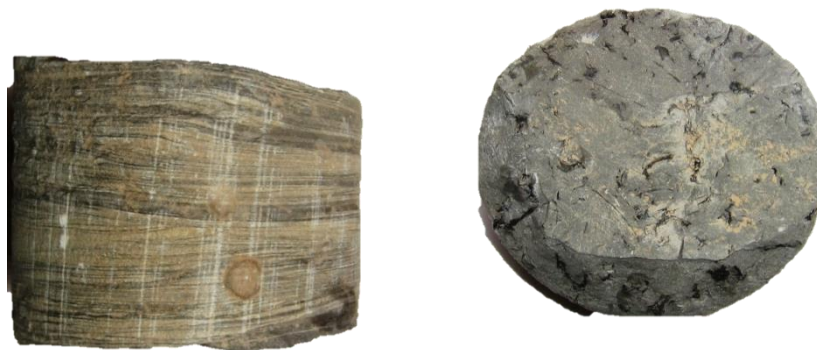
Qora ko'mirlashgan argillit bilan mayda-o'rta donali qumtoshning ketma-ket qatlamlanishi Oraliq.3221,51-3220,21m .quduq. Atarboy-1
