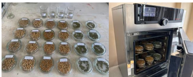
2-rasm. Dukkakli don ekinlar urug'larning unuvchanligini laboratoriya sharoitida aniqlash
