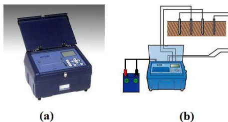
3-rasm. McOHM-El elektr qidiruv qurilmasi: a) McOHM-El asbobi ko'rinishi b) McOHM-El asbobining ishlash sxemasi. [4]
