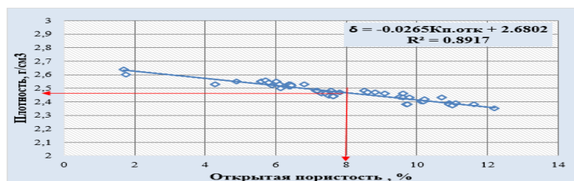
Рисунок 6. Связь объемной плотности от коэффициента открытой пористости
