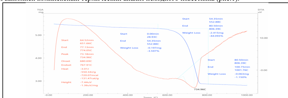
Рисунок 1 – Кривые ДТА и ТГ исходного известняка
