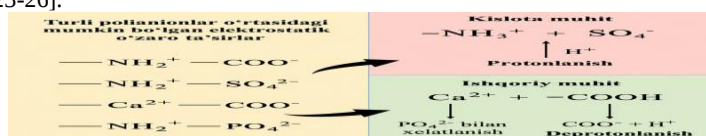
1-rasm. Polielektrolit kompleks (PEC) va IPN (o'zaro kirishgan polimer tarmoq) tizimlarini tarkibidagi turli polionlarning mumkin bo'lgan ionli o'zaro ta'sirlari va ionli harakatlari
