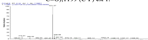
2-rasm. Mahsulotning Mass spektri. HR-ESI-MS m/z 521.07 [M - H] - (umumiy formula C 20 H 13 F 3 N 6 O 8 , 522.22).
