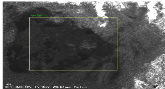
2. Rasm. EG-1 markali polimer qoplama hosil qiluvchi korroziya ingibitorining elektron-mikroskopik tahlili.
