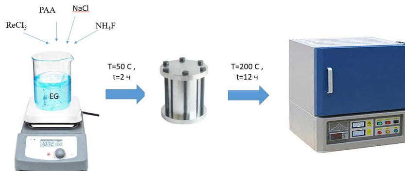
Рис.1. Схема синтеза квантовых точек NaYF 4 :Er/Yb
