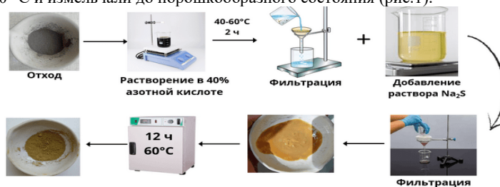
Рис.1. Схема получения композита CdS/ZnS/CuS
