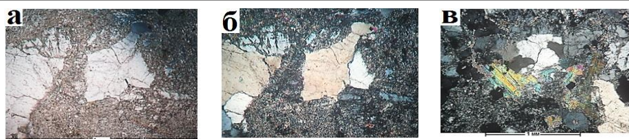
2-расм. Албит-хлорит-серицитли (апогранитли) метасоматитларнинг минерал таркиби ва текстуравий-структуравий хоссалари: а – николлар параллел; б, в – николлар кесишган.
