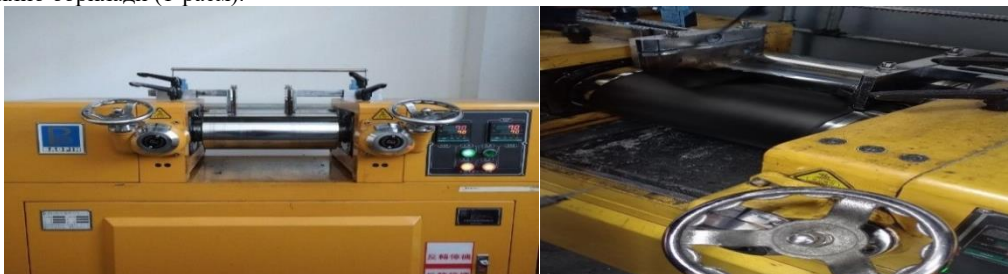
1-расм: Вальц жиҳози, модели SN-8175
