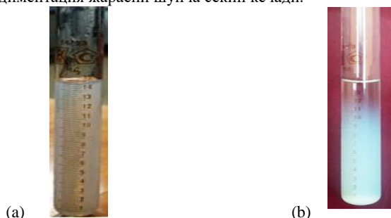
7-расм. (а)-наносуюклик тайёрлангандан кейинги ҳолати ( 40 \text{ нм} , 0,5\% массавий улушда тайёрланган). (б)- наносуюклик тайёрлангандан 35 кун ўтгандан кейинги ҳолати.
