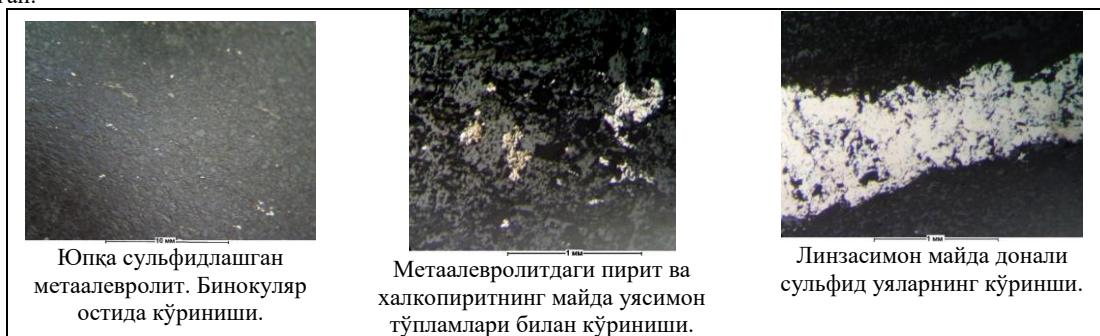
2-расм. Тоғ жинсларининг таркибида сульфид минералларини аншлифтларда кўриниши.
