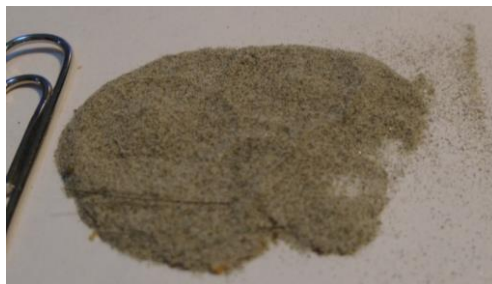
Фото.1.3. Мелкая фракция кварцевых песков обр. №3, после обработки соляной кислотой. (Фото. А.Д. Гончар).
