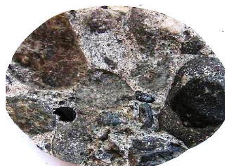
Рис. 2. Матрикс в конгломерате выполнен мелкораздробленным материалом. Тедженказган-1. инт.3332,7-3337,0м.
