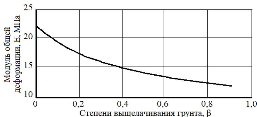
Рис. 2. Изменение модулей общей деформации грунтов в зависимости от степени выщелачивания супесчаного грунта
