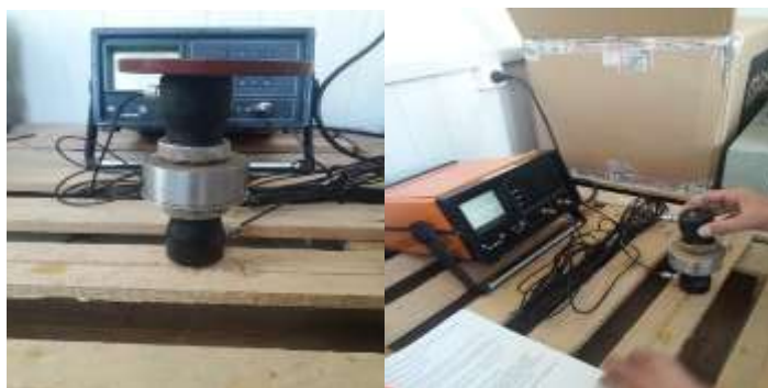
Рис.1. Процесс определения скорости распространения продольной волны в ультразвуковом приборе (УК-10ПМС)
