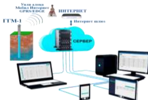
1-расм. Гидрогеологик объектлардан маълумот алмашинуш жараёнининг умумий структураси
