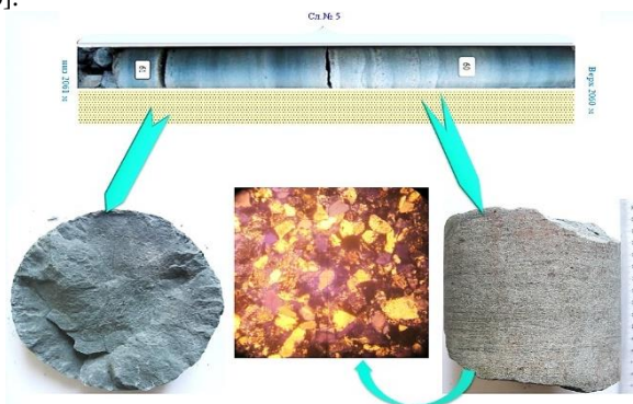
8-rasm. Oksford yarusi yotqiziqlarining litologo-petrofizik xususiyatlari, qud. Sulama-1
