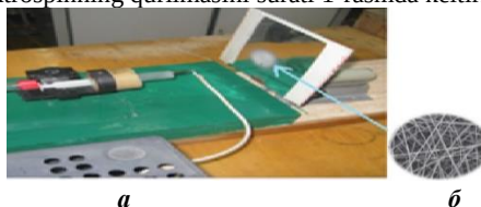
1-rasm. Elektrospinning qurilmasi (a) va nanotolalar (b)
