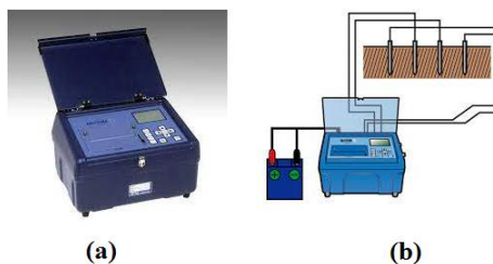
3-rasm. McOHM-El elektr qidiruv qurilmasi: a) McOHM-El asbobi ko'rinishi b) McOHM-El asbobining ishlash sxemasi. [4]
