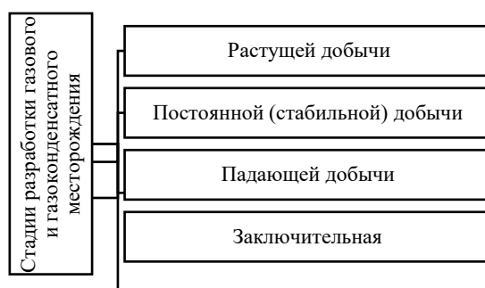
Рисунок – 1. Стадии разработки газового и газоконденсатного месторождения
