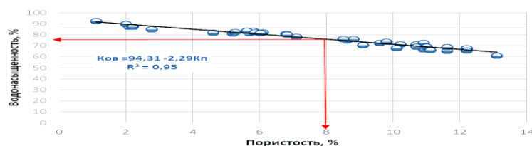
Рисунок 5. Зависимость k_{ов}=f(k_{п}) коэффициента остаточной водонасыщенности от коэффициента открытой пористости для терригенных пород средней и нижней юры.
