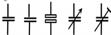
1-rasm. Kondensatorlarning elektr sxemalarda shartli belgilanishi: uzgarmas (a), kutli(b), kutbsiz (v), uzgaruvchan (g) va sozlovchi (d).
