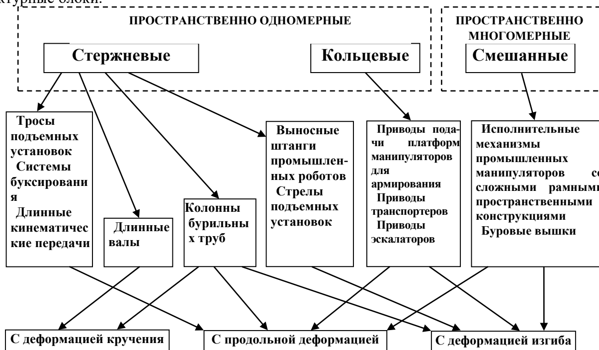
Рис. 2. Классификация исполнительных механизмов с распределенными параметрами электромеханических систем.
