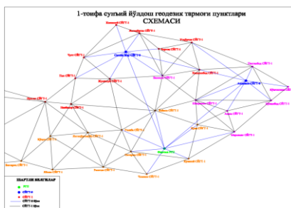
2-rasm. Farg'ona vodiysi 1-sinf sun'iy yo'ldosh geodezik tarmog'i (SYGT-1) punktlari
