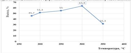
Таблица 5 Влияние температуры на выход винилового эфира валериановой кислоты (катализатор Al<sub>2</sub>O<sub>3</sub>/Zn(C<sub>4</sub>H<sub>9</sub>COO)<sub>2</sub>)
