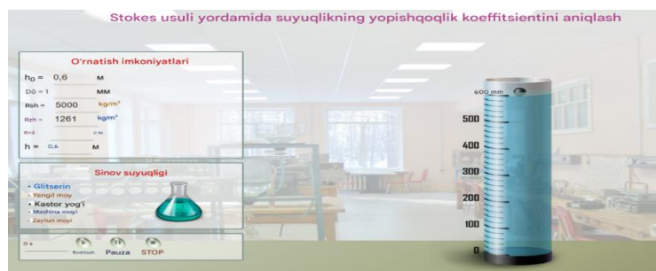
1-rasm. “Stoks usuli yordamida suyuqlikning yopishqoqlik koeffitsiyentini aniqlash” mavzusidagi virtual laboratoriya ishining umumiy ko'rinishi
