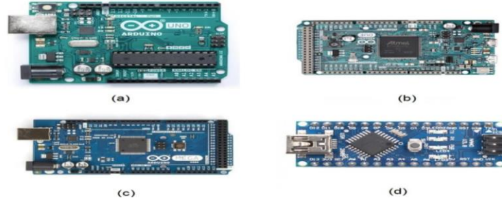
1-rasm. Arduino turlari: (a) Arduino Uno, (b) Arduino Due, (c) Arduino Mega (d) Arduino Nano
