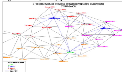
2-rasm. Farg'ona vodiysi 1-sinf sun'iy yo'ldosh geodezik tarmog'i (SYGT-1) punktlari
