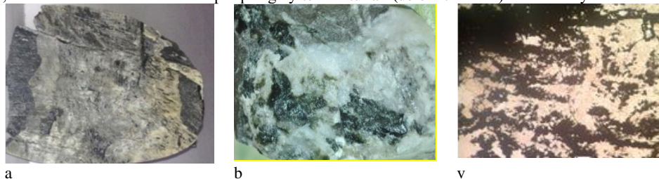
2-rasm. Sulfidli minerallashuvi bo'lgan karbonat-kaolinitli tomircha (a); kvars-karbonatli o'zgarishlarning chegaralari bo'ylab tog' jinslarining xloritlashuvi (b); argillizitlarning mayda zarrali karbonat-kaolinitli (qora rangli kaolinit) zonasi (v – shaffof shlif, nikollar II).
