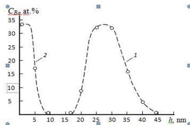
Рис.1. Концентрационные профили распределения Ba по глубине для Si, имплантированного ионами  $\text{Ba}^+$  с  $E_0 = 30$  кэВ – 1 и 1 кэВ – 2. После каждого цикла имплантации проводился прогрев при  $T \approx 900$  К.
