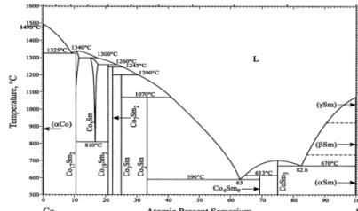
**1-rasm** Sm-Co sistemasi fazaviy holat diagrammasi[16].
