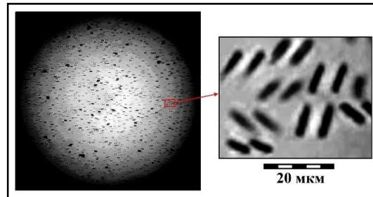
**4-rasm.** Taglik sirtida dixlorbenzoldagi  $\text{C}_{70}$  molekulyar eritmasining bug'langan tomchisida sintez qilingan bir o'lchovli strukturalarining optik mikroskopik tasviri
