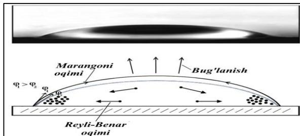
**1-rasm.**  $C_{70}$  eritmasining mikrotomchisi fotosuratu (yuqorida) va bug'lanayotgan tomchi ichida sodir bo'ladigan oqimlarning sxematik tasviri (pastda).
