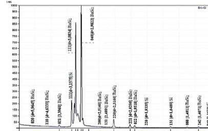
Рис. 2. Рентгенограмма поверхности системы  $\text{BaSi}_2 / \text{Si} / \text{BaSi}_2 / \text{Si}$  (111).
