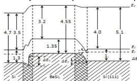
Рис. 3. Энергетическая зонная диаграмма для сверхрешетки  $\text{Si}/\text{BaSi}_2/\text{Si}$  (111).
